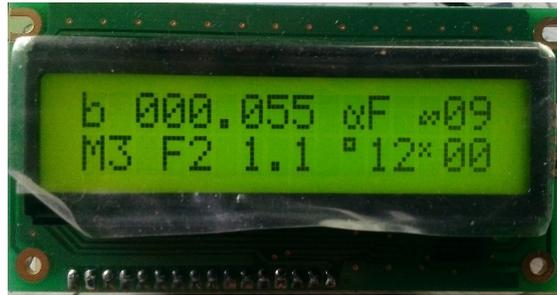
Abbildung 1: Frequenznormal derzeit auf **0.055 ppb** (Parts Per Billion) genau
