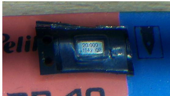
Abbildung 16: VCTCXO für 20 MHz: dieses Bauteil im Container, Größenvergleich anhand eines Radiergummis
