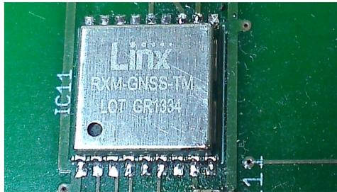
Abbildung 17: GPS-Receiver von Linx – navigiert mit GPS-, Galileo-, QZSS- wie auch mit Glonass-Satelliten
