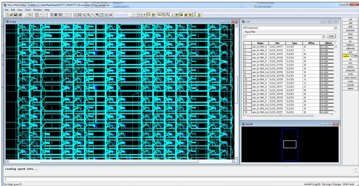
Abbildung 3: FPGA Aufbau: sichtbar die „Signal-Straßen“ und die „Funktions-Blöcke“
