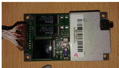
Abbildung 11: Das **Rockwell-Jupiter-GPS TU30-D440** Modul mit MCX-Buchse und doppelreihiger 2 mm-Stiftleiste
